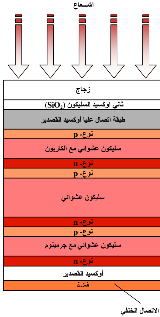
شكل (10-3): استخدام طبقتين من الأغشية الرقيقة لتحسين كفاءة الخلية الشمسية العشوائية مع الاستخدام
