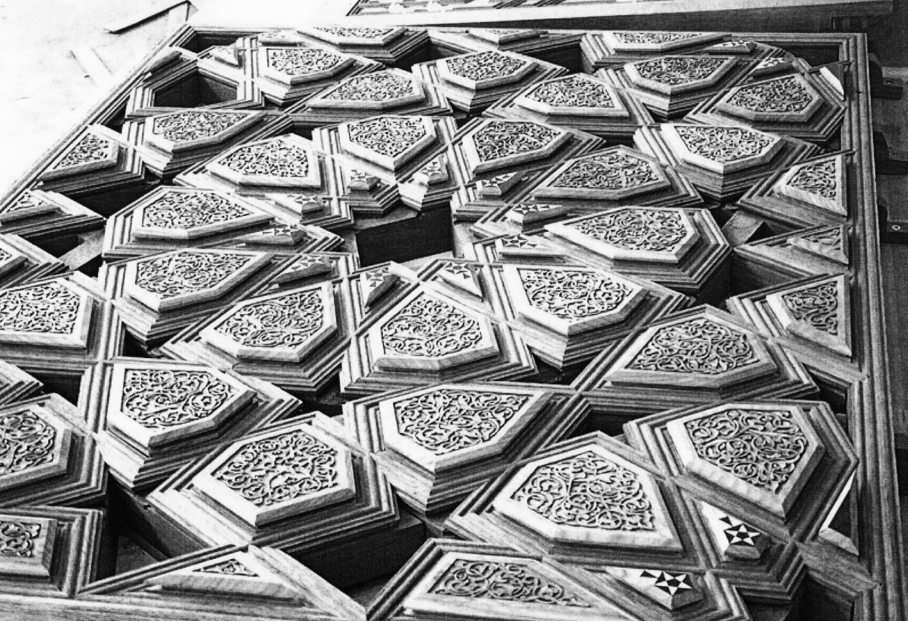
7 - بدء تجميع الحشوات المزخرفة ضمن هيكل المنبر
